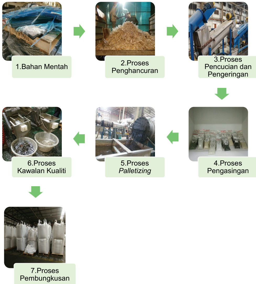
Rajah 8-1 Proses Penghasilan Plastik PC Secara Umum
